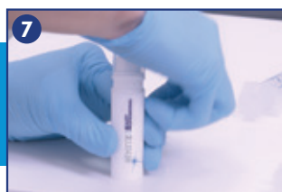
7 Quando il dispenser è stato riempito di gel, posarlo su un ripiano stabile, prendere il beccuccio (senza togliere il tappo) e appoggiarlo sul dispenser: per completare la chiusura tenere il dispenser e utilizzare il palmo dell'altra mano per premere con forza fino al completo inserimento dell'erogatore.
